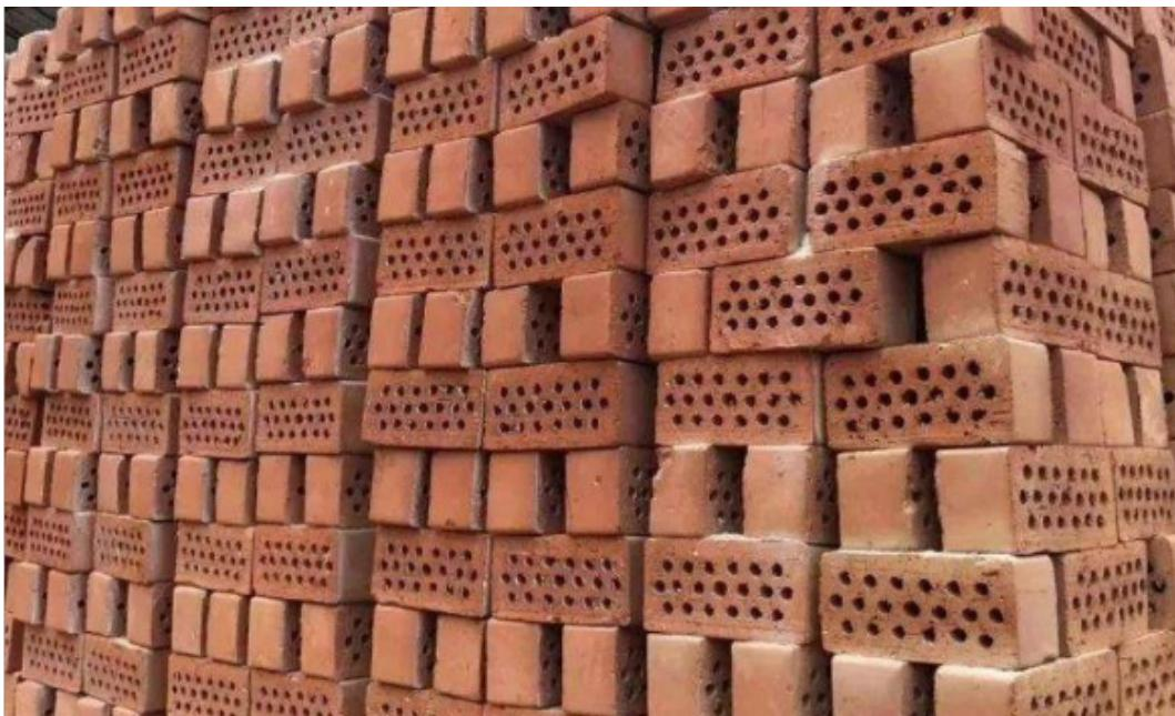
煤矸石经自燃或人工煅烧后具有一定活性，可掺入水泥中作活性混合材，与熟料和石膏按比例配合后入水泥磨磨细。煤矸石的掺入量取决于水泥的品种和标号，在水泥熟料中掺入15%的煤矸石，可制得325号—425号普通硅酸盐水泥；掺量超过20%时，按国家规定为火山灰硅酸盐水泥。用煤矸石作混合材时，应控制烧失量 $\leq 5\%$ ， $\text{SO}_3 \leq 3\%$ ，火山灰性试验必须合格，水泥胶砂28天抗压强度比 $\geq 62\%$ 。煤矸石是很好的筑路材料，有很好的抗风雨侵蚀性能，并可降低筑路成本。以上就是煤矸石的综合利用现状，目前这些技术，还存很多的问题，如：对煤矸石的利用率不高，技术不太成熟，没有形成固定的模式等等。德化煤矸烧结多孔砖厂家烧结多孔砖主要是以粘土、页岩、粉煤灰为主要原料，经成型、焙烧而成。
