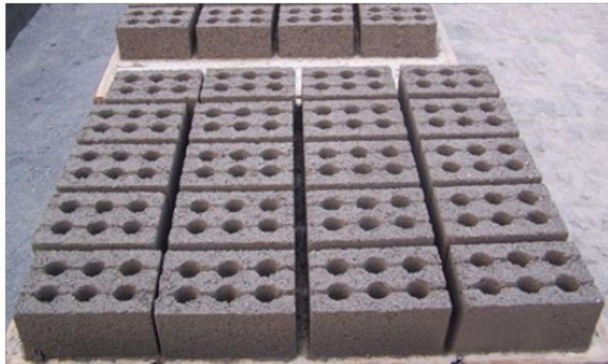
现在的建筑工程，除了全部采用钢结构，很少离不开砖，我们天天与砖打交道，还是有必要知道墙体砌筑的一些要求！1、墙体上下错缝，内外搭砌，宜采用一顺一丁或梅花丁的砌筑方式，砖柱不得采用包心砌法。2、砌体灰缝应横平竖直，水平灰缝宽度宜为10mm但不应小于8mm不应大于12mm。3、砌体应采用一铲灰、一块砖、一揉压的‘三一’砌筑方法。砌体灰缝砂浆应饱满，水平灰缝的砂浆饱满度不得低于80%，竖向灰缝应采用加浆填灌的方法，使其砂浆饱满，严禁用水冲浆灌缝。4、砌体砌筑前应试摆砖，错缝搭接长度不少于1/3砖长。砌筑砌体时，多孔砖的孔洞应垂直于受压面。
